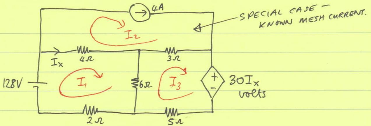
mesh ①:  $-128 + 4(I_1 - I_2) + 6(I_1 - I_3) + 2I_1 = 0$
