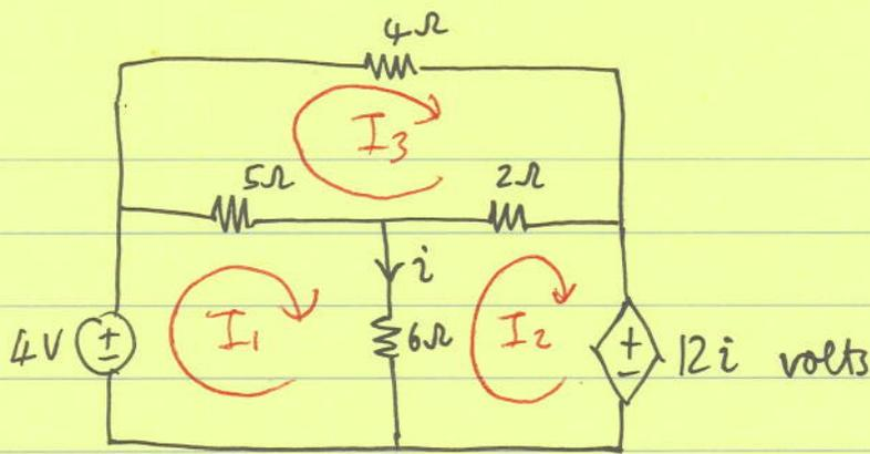
$$\text{mesh ①} : -4 + 5(I_1 - I_3) + 6(I_1 - I_2) = 0 \quad \dots \text{①}$$
